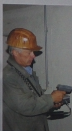
Auftriebsmessungen Piezometer und Sohlwasserspiegels des Untergrundes
