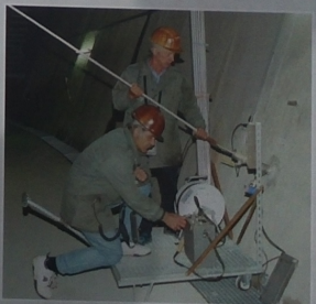
Verformungen Gleitmikrometer erfassen Verformungen bzw. Risse der Mauer oder des Untergrundes auf einen Tausendstel Millimeter genau.
