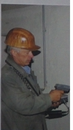
Auftriebsmessungen Piezometer und Sohlwasserspiegelmessungen im Untergrund.
