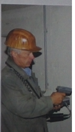
Auftriebsmessungen Piezometer und Sohlwasserdruck im Untergrund werden gemessen.
